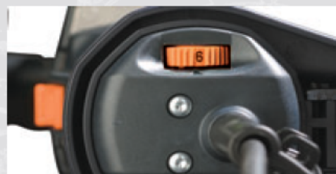
Regolazione elettronica della velocità per adeguarla alla superficie di lavoro.
